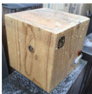
WOODEVA 杉芯持材に塗布後 17箇月間屋外暴露で割れ無し
